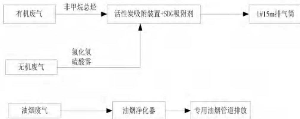
图 4-1 项目废气收集及处理工艺流程框图
