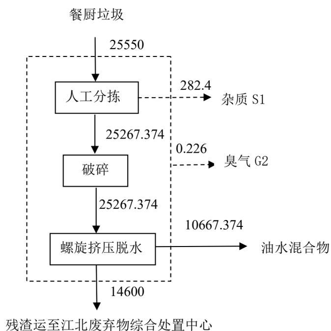
图 4.2-1 本项目餐厨垃圾处置物料平衡图（单位：t/a）
