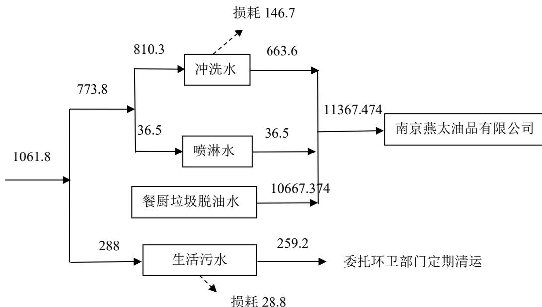
图 4.2-2 建设项目用水平衡图 (单位: t/a)
