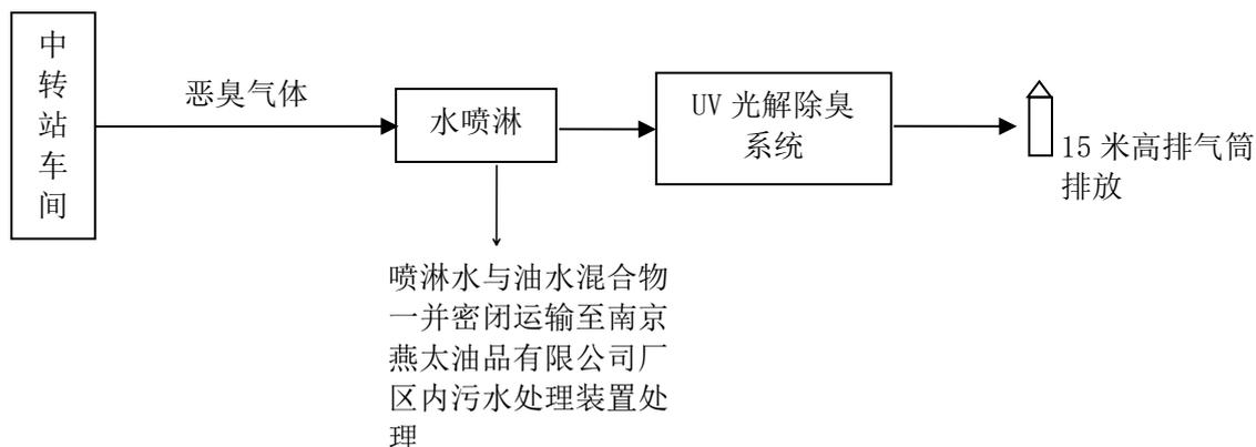
图 7.1-1 建设项目废气收集处理流程图
