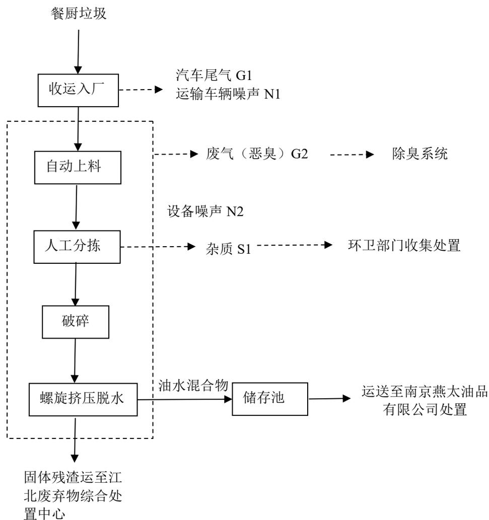
图 4.1-1 餐厨垃圾处理工艺流程图
