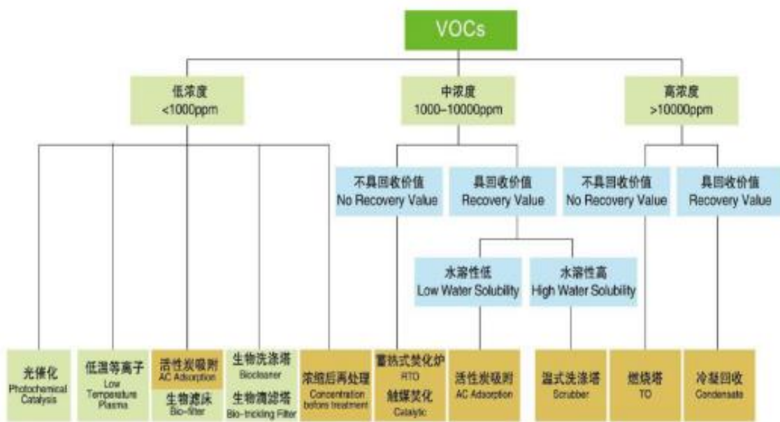
图 8-2 不同有机废气处理方式比较
