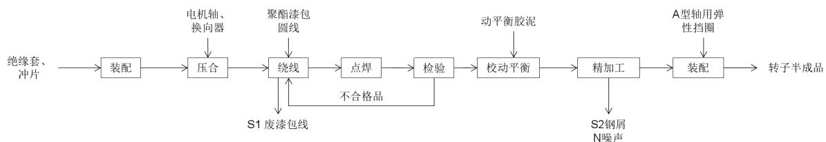
图 5-1 转子生产工艺流程图
