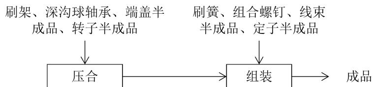
图 5-5 永磁直流电机生产工艺流程图
