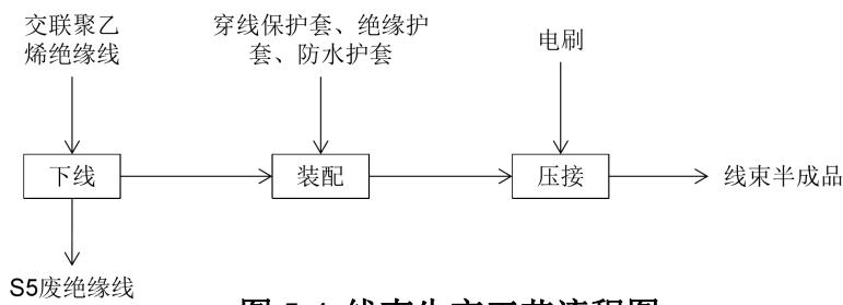
图 5-4 线束生产工艺流程图
