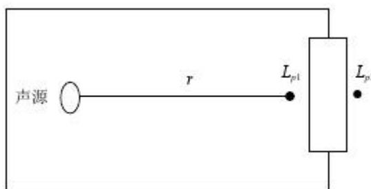
图 7-1 室内声源等效为室外声源图例
