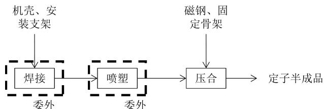
图 5-2 定子生产工艺流程图
