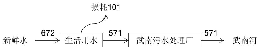
图 5-6 全厂水量平衡图 单位: t/a
